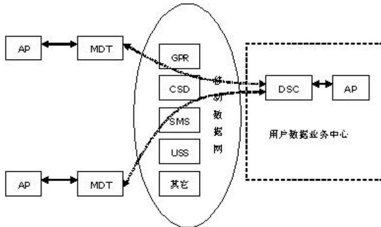
图2-4：中心点-多点数据传输应用示意图
