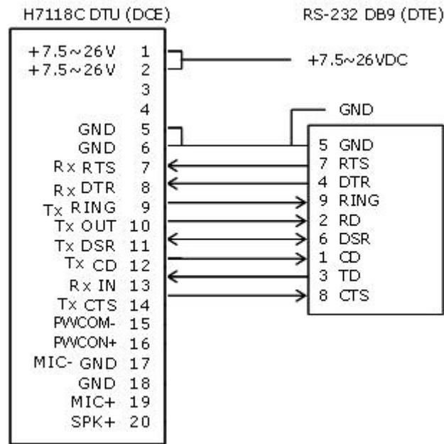
图2-8: H7118C RS-232 DCE用户数据接口电缆接线示意图
