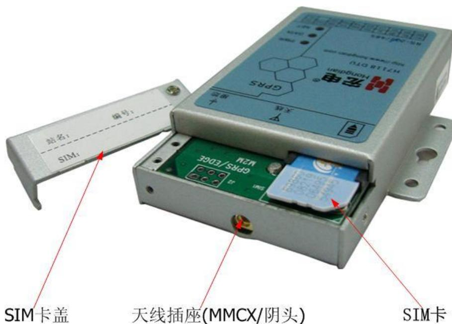
图2-7: SIM卡安装图示
