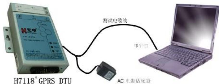
图3-1: H7118配置连接示意图
