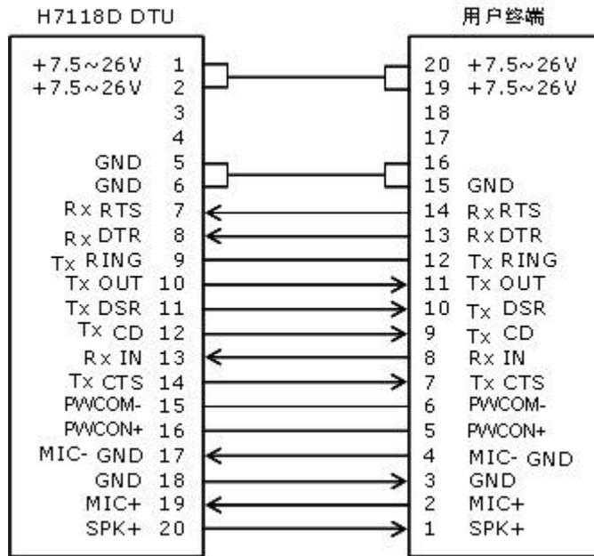
图2-8: H7118D用户数据接口电缆接线示意图
