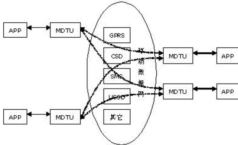
图2-5：多点-多点数据传输应用示意图
